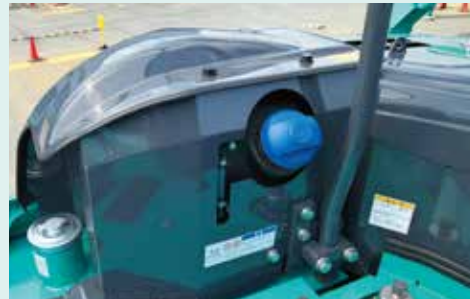
尿素水タンク給水口
