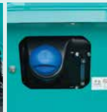
尿素水タンク給水口
