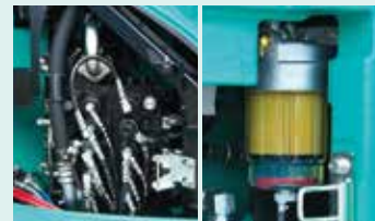
コントロールバルブ/燃料プレフィルタ
