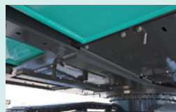
アッパ底部の鋼材補強
