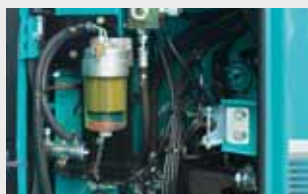
右サイドガード：コントロールパ ン/マルチコントロール/燃料フィル タ/他
