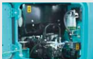
右後方ガード：油圧ポンプ/エンジン オイルフィルタ/ウォーターセパレータ ー燃料プレフィルタ/他
