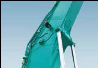
HD2 ポジションブーム 標準ブームに比べて大きな作業高さとな作業半径を実現。
