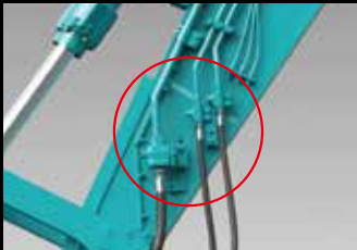
回転F&G 配管 先端アタッチメントにフォークグリップまたはグラブバケットの装着が可能。
