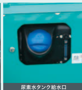
尿素水タンク給水口
