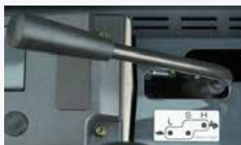
モード選択はスロットルレバーをSポジションに。
