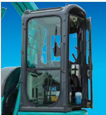
乗降時に大きなドア開閉スペースを必要としないスライドドアを採用。壁際ぎりぎりでも開閉できます。
