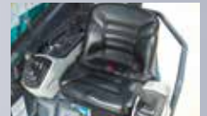
雨水が溜まりにくいシート。
