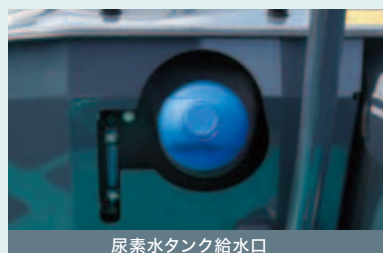
尿素水タンク給水口
