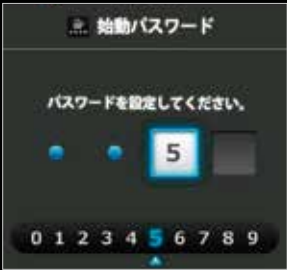
エンジン始動パスワード 初回時はサービス工場でのセットが必要となります。
