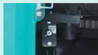
バッテリー遮断スイッチ
