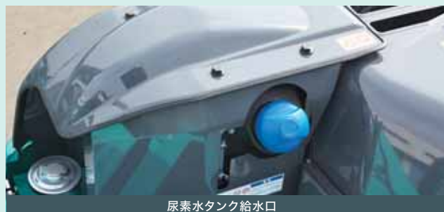
尿素水タンク給水口
