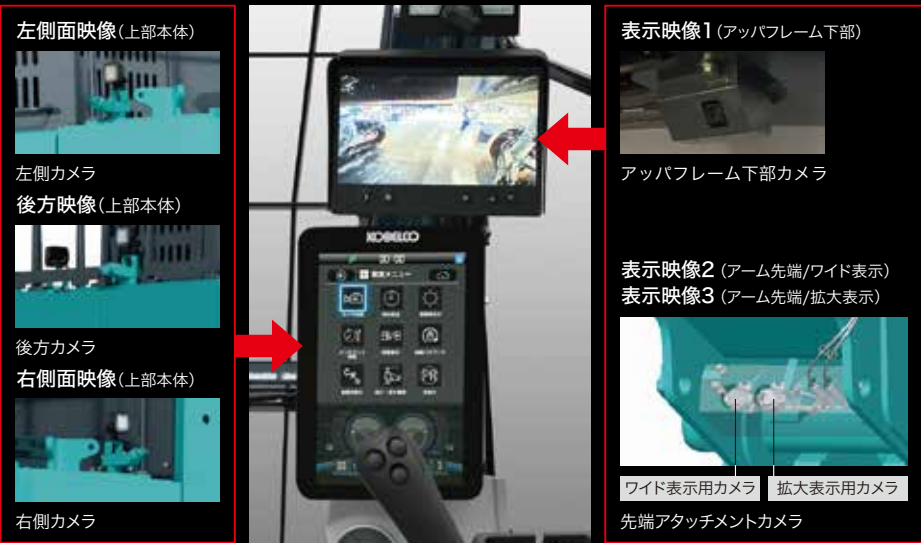
※先端アタッチメントカメラは超ロングアタッチメント仕様機のみを搭載 ※映像切り替えはアッパフレーム下カメラと先端アタッチメントカメラ(ワイド表示/拡大表示)の3モード切り替え
