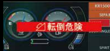
転倒危険警告表示
