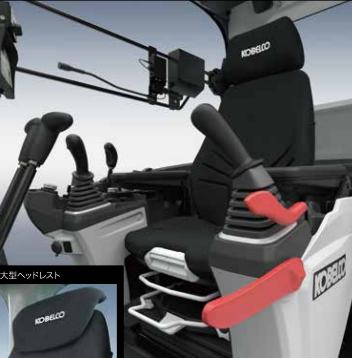
見上げる姿勢を長時間強いられる高所解体に適した30°チルトキャブ 広く、安全確認しやすい作業視界を確保したDSキャブ 縦開閉のロールブラインドを採用した天窓 4つ折れ超ロング仕様機用操作レバーを手元に配置
